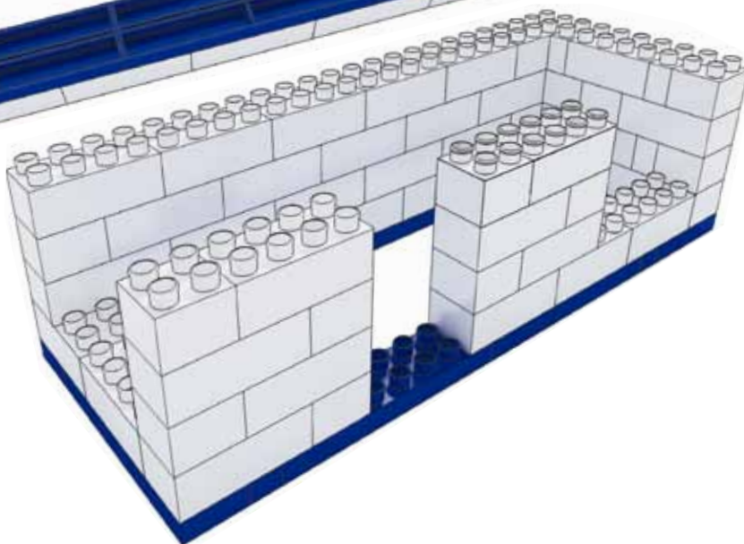
Fig. | 3 Montado primeras tres hiladas de ladrillos vista frontal
