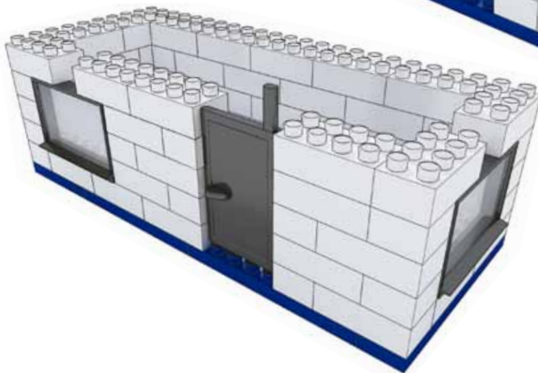
Fig. | 6 Montado de puerta y colocación de una hilada más vista frontal
